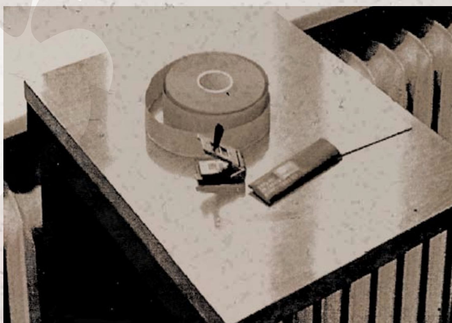
Akcesoria programisty – tasiemka papierowa, chińczyk – ręczny dziurkacz oraz przymiar do sprawdzania poprawności rozsuwu dziurek
