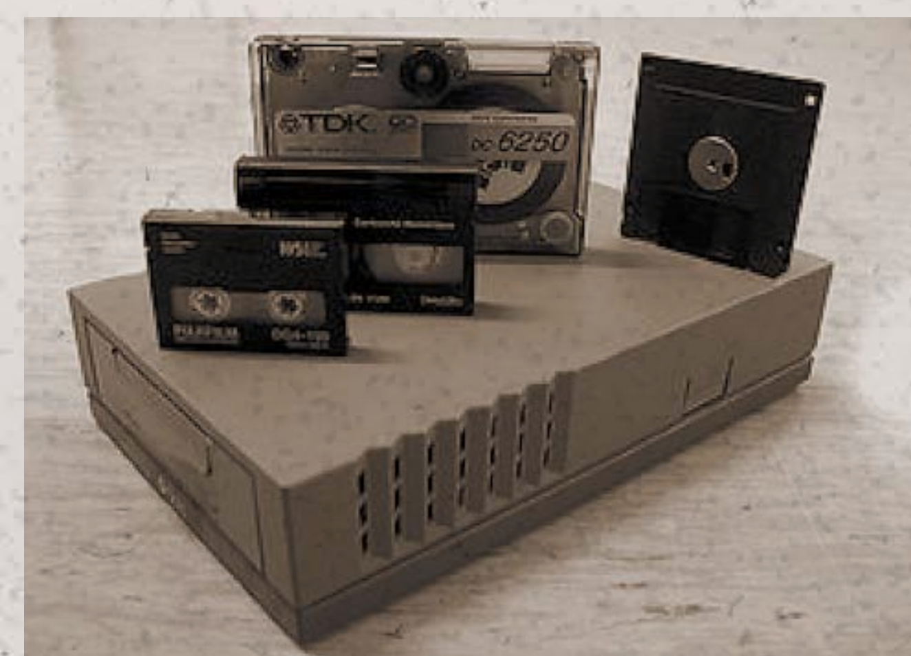
Napęd taśmowy DDS, na nim od prawej: dyskietka 3,5", taśma DC (250 MB, 6 mm, 310,9 mb), taśma DL (20 GB, 8 mm, 112 mb), taśma DDS (4 mm, 150 mb)
