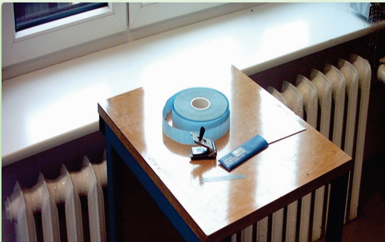
Aksesoria programisty - tasiemka papierowa, chińczyk – ręczny dziurkacz oraz przymiar do sprawdzania poprawności rozstawu dziurek
